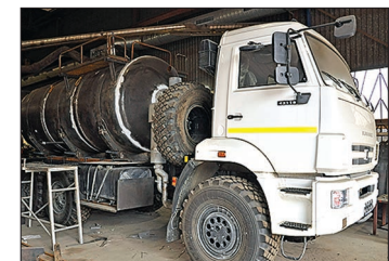
Новая для завода «Капри» модель — «АКН-10» на шасси КамАЗ-43118 с цистерной для перевозки метанола, изготовленная для «Когалымского УТТ».
