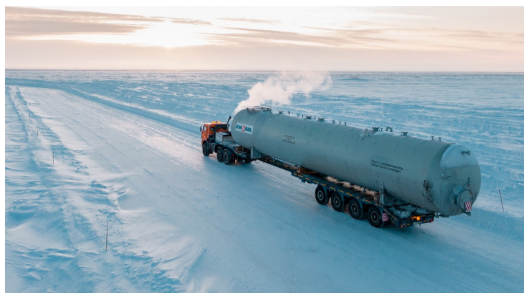
В конце апреля на Восточно-Мессояхское месторождение по автозимнику, построенному ООО «Дорстройсервис», был доставлен электродегидратор для глубокого обезвоживания и обессоливания высоковязкой арктической нефти. Стратегически важное оборудование весом более 50 тонн стало одним из самых тяжелых и негабаритных грузов, завезенных на промысел с начала промышленной эксплуатации. Фото: АО «Мессояханефтегаз».
