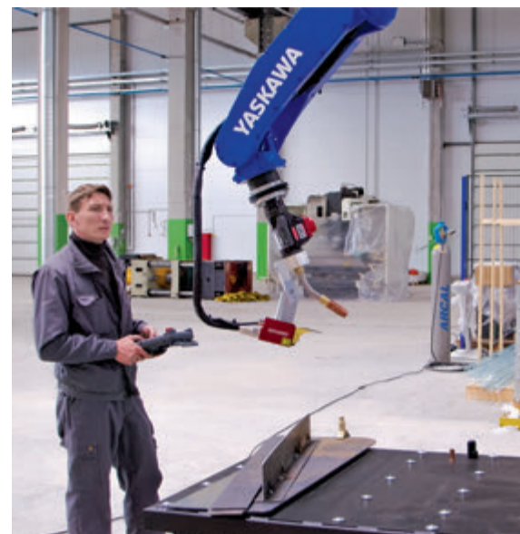
Идет настройка роботизированного сварочного комплекса.
